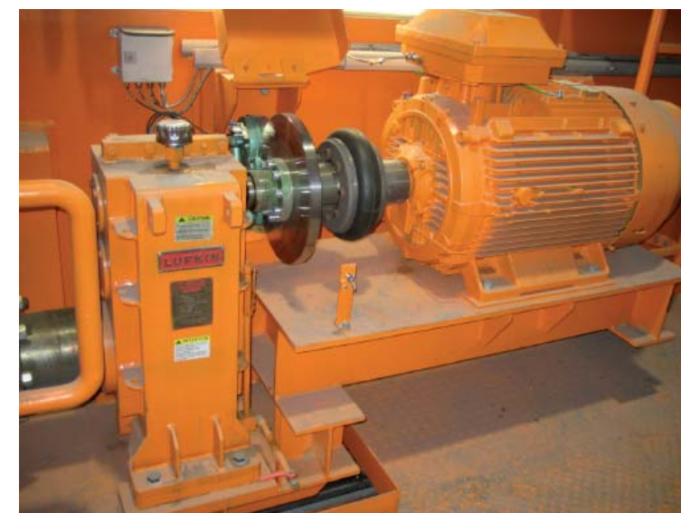
Exempel på travers med intensiv arbetscykel och broms med 0-varvstillslag hos SSAB Oxelösund.
